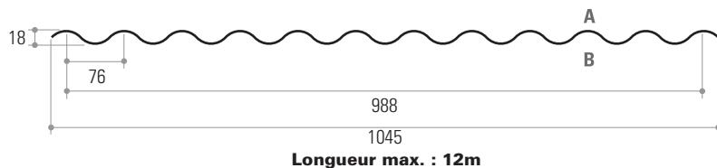
**APPLICATION** Tôle pour bardage ou toiture / bardage pose horizontale ou verticale
